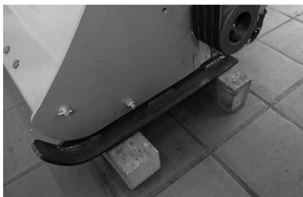
Fig. 10 Soulèvement de la broyeuse
