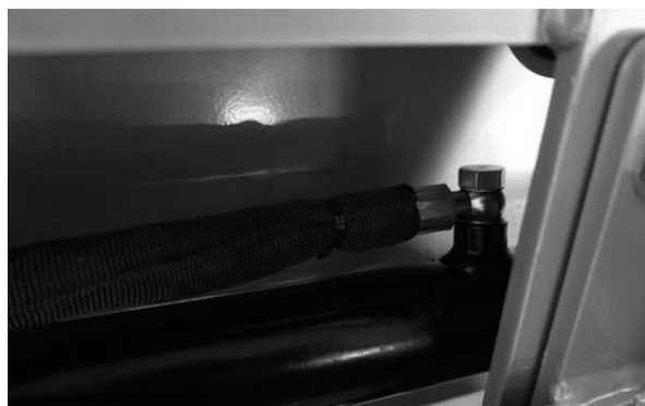
Fig. 17 Conduite hydraulique droite
